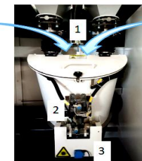
混砂部分 ①砂桶 ②混砂罐 ③料位计
