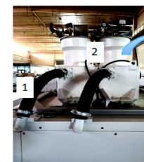
吸砂部分 ①吸砂管 ②砂斗
